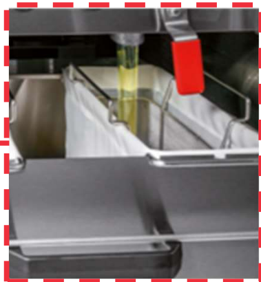
Fig.2 : Système de filtration de l'huile
